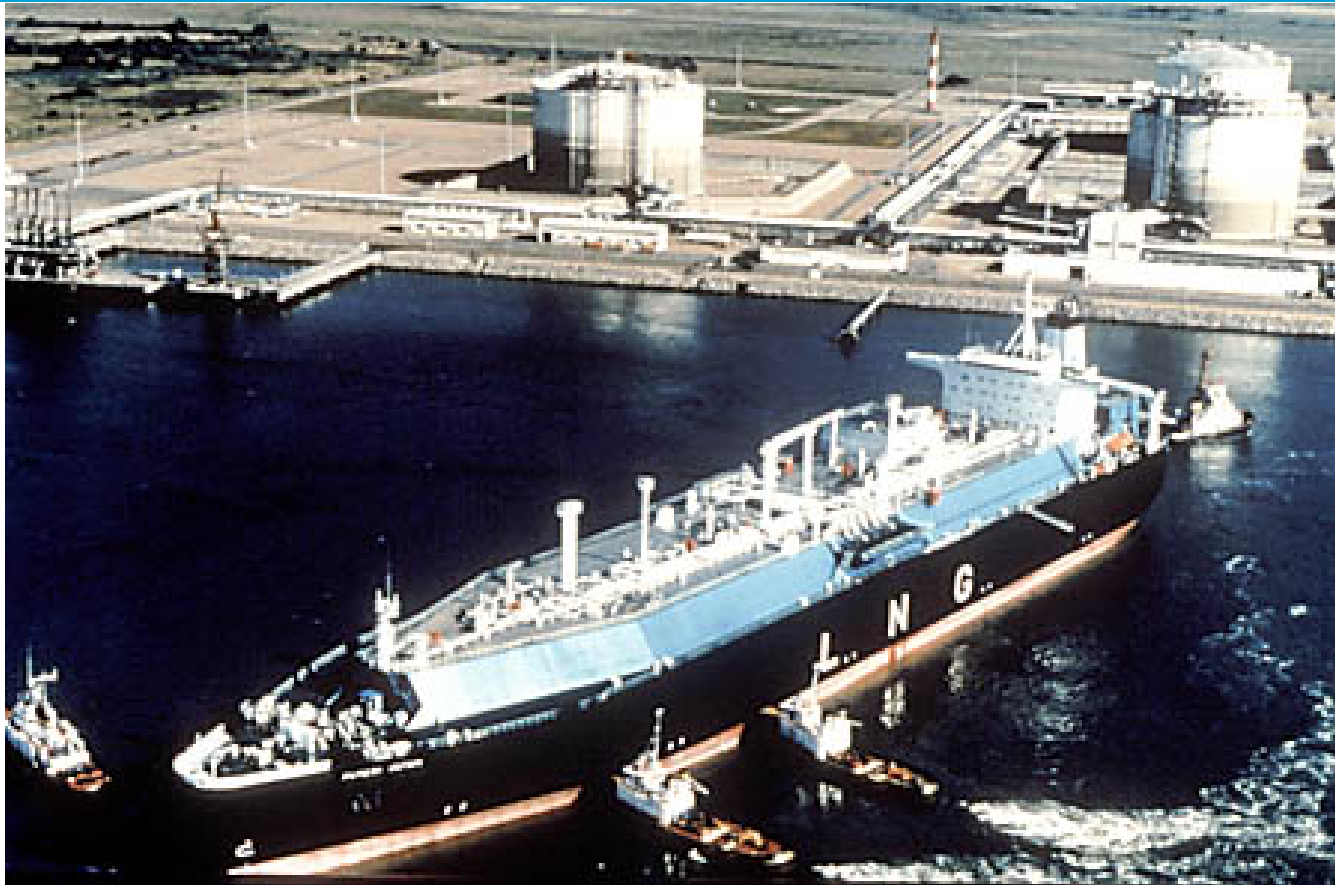
130 000 m 3 LNG carrier with double hull
